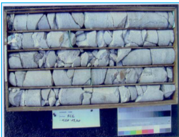
Figure 5: Caisse de carottes issues d'un sondage carotté vertical dans une structure en maçonnerie
